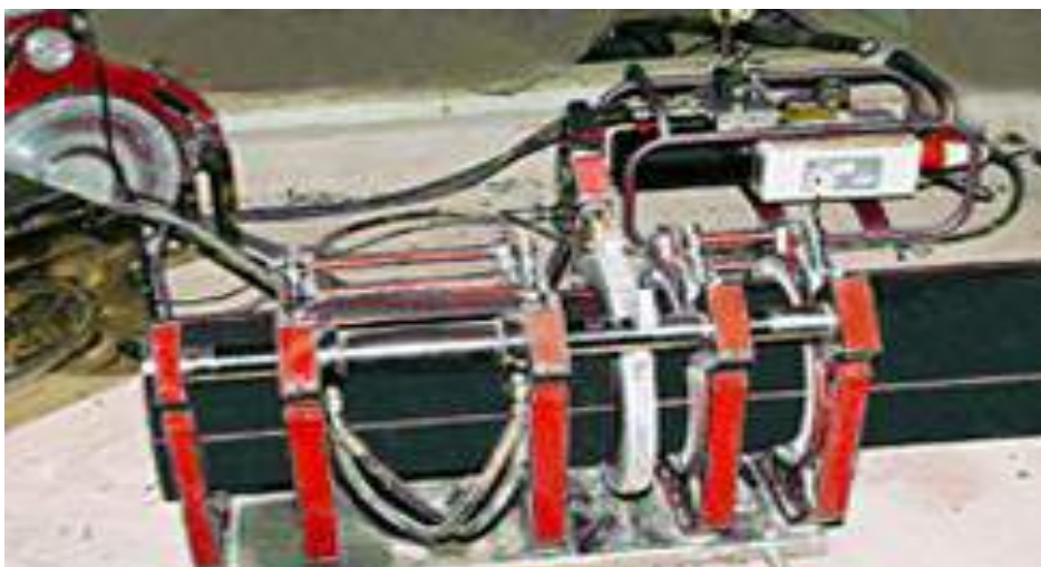
Hình 1.14. Cho máy hàn gia nhiệt kẹp giữa 2 đầu ống
