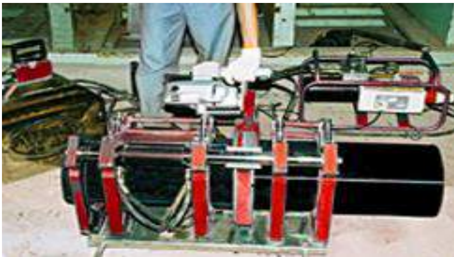
Hình 1.13. Máy bào vào bào nhẵn hai đầu ống
